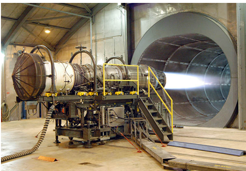
รูปที่ 1.5 การทดสอบเครื่องยนต์เทอร์โบแฟน (turbofan engine) ซึ่งเป็นหนึ่งในหน้าที่ของวิศวกรรมการบินและอวกาศ (aerospace engineer)
